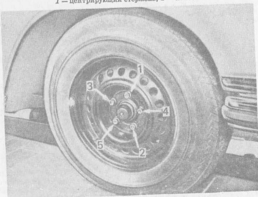
Рис. 52. Последовательность затяжки болтов крепления колес
